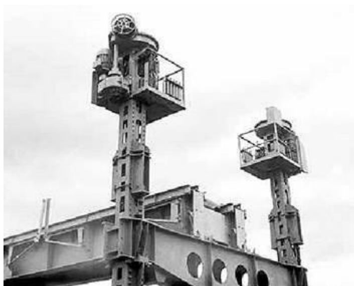
Рис. 3.24. Установка для завинчивания свай УЗС-10
