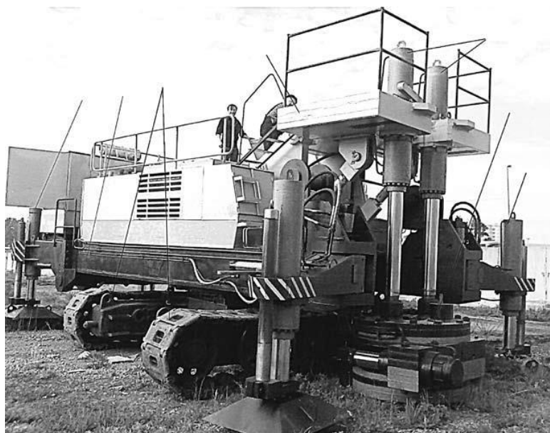
Рис. 3.21. Установка вдавливания свай UCS 160 на гусеничной тележке экскаватора ЭО - 6122
